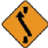
Путепровод с одной полосой (въезд)
