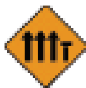
Prawy pas (z czterech) zamknięty
