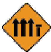
右侧车道（四车道）封闭
