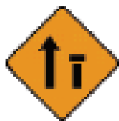
右侧车道（双车道）封闭
