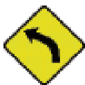
前方危险弯道
